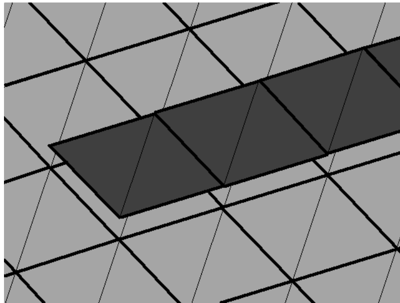
Rysunek 4.1: Prostokąty tworzymy w oparciu o siatkę trójkątną
